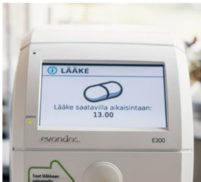
Lääkerobotin ruudulta näkee, koska lääke on seuraavan kerran saatavilla. Lääkepussi tulee ulos robotin alaosan pienestä aukosta.
